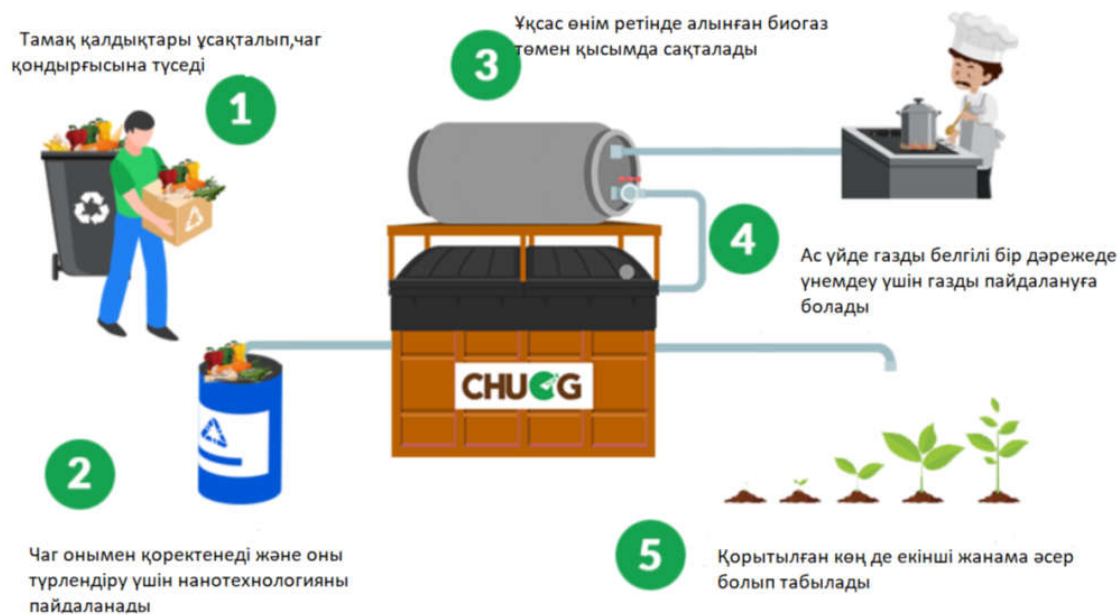
5 - сурет -Чагг қондырғысының жұмыс істеу технологиясы
