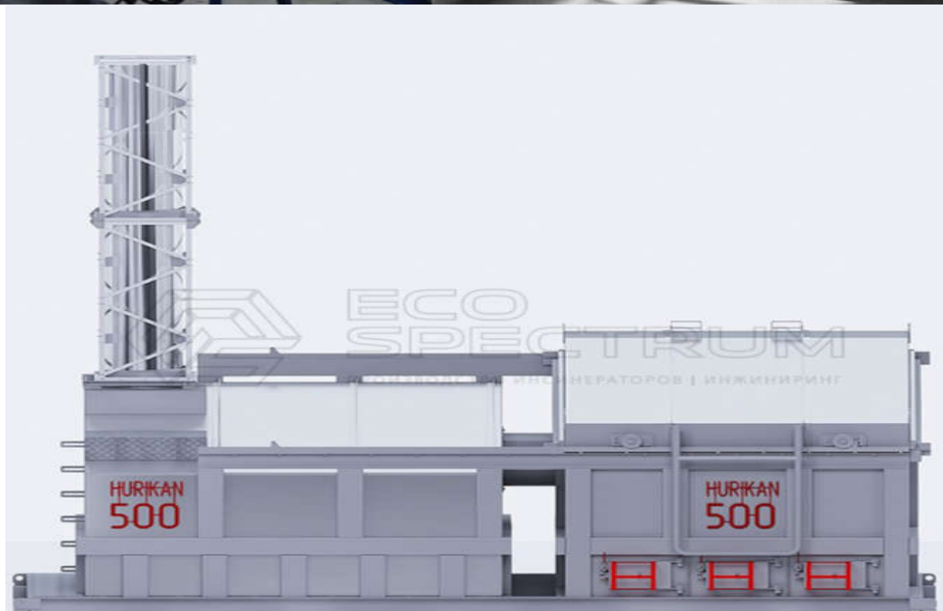
17 - сурет -HURIKAN» 500 қондырғысының моделі
